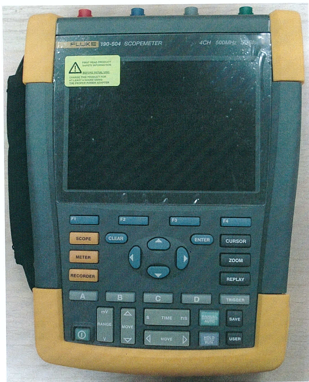
Рисунок 1 – Общий вид осциллографов Fluke 190. Вид спереди
