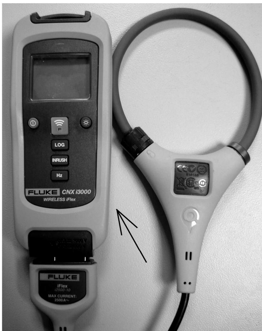
Рисунок 1 - Внешний вид измерителя, стрелкой показано место нанесения знака утверждения типа.
