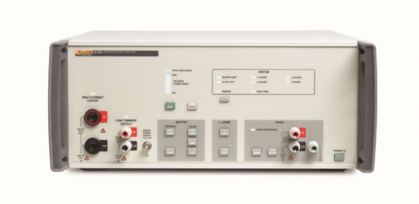
Рисунок 1- Передняя панель усилителей тока Fluke 52120A
