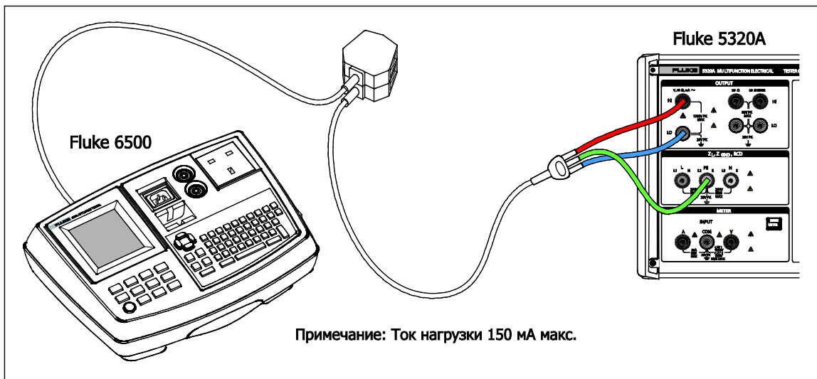
Рис. 7-19. Калибровка напряжения на тестерах электробезопасности с питанием от сети
