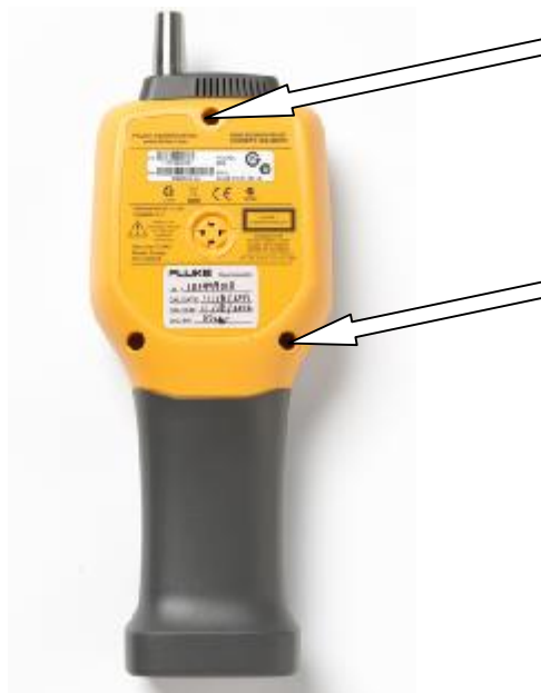
Рисунок 2 – Схема пломбировки счетчика частиц от несанкционированного доступа
