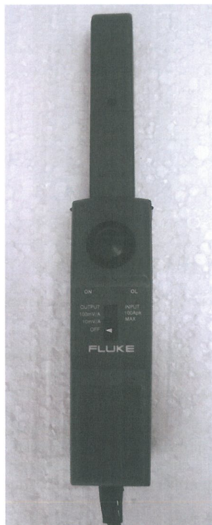
Рисунок 1 - Внешний вид клещей модели Fluke 80i-110s, стрелкой показано место нанесения знака утверждения типа.
