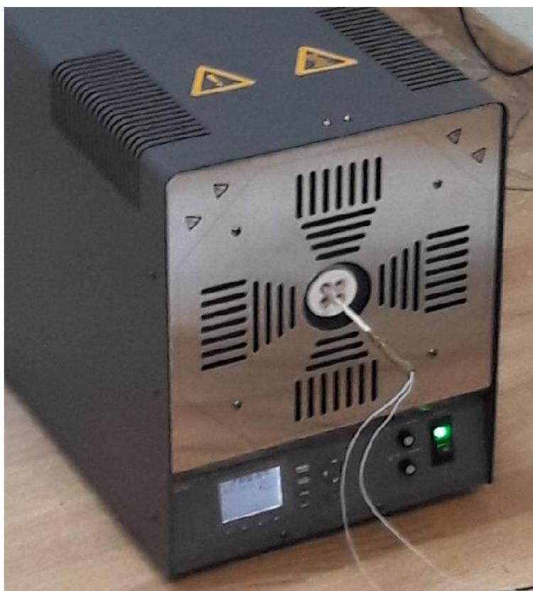
Рисунок 2 – Внешний вид печи в исполнении с изотермическим блоком 9118А-ИТВ
