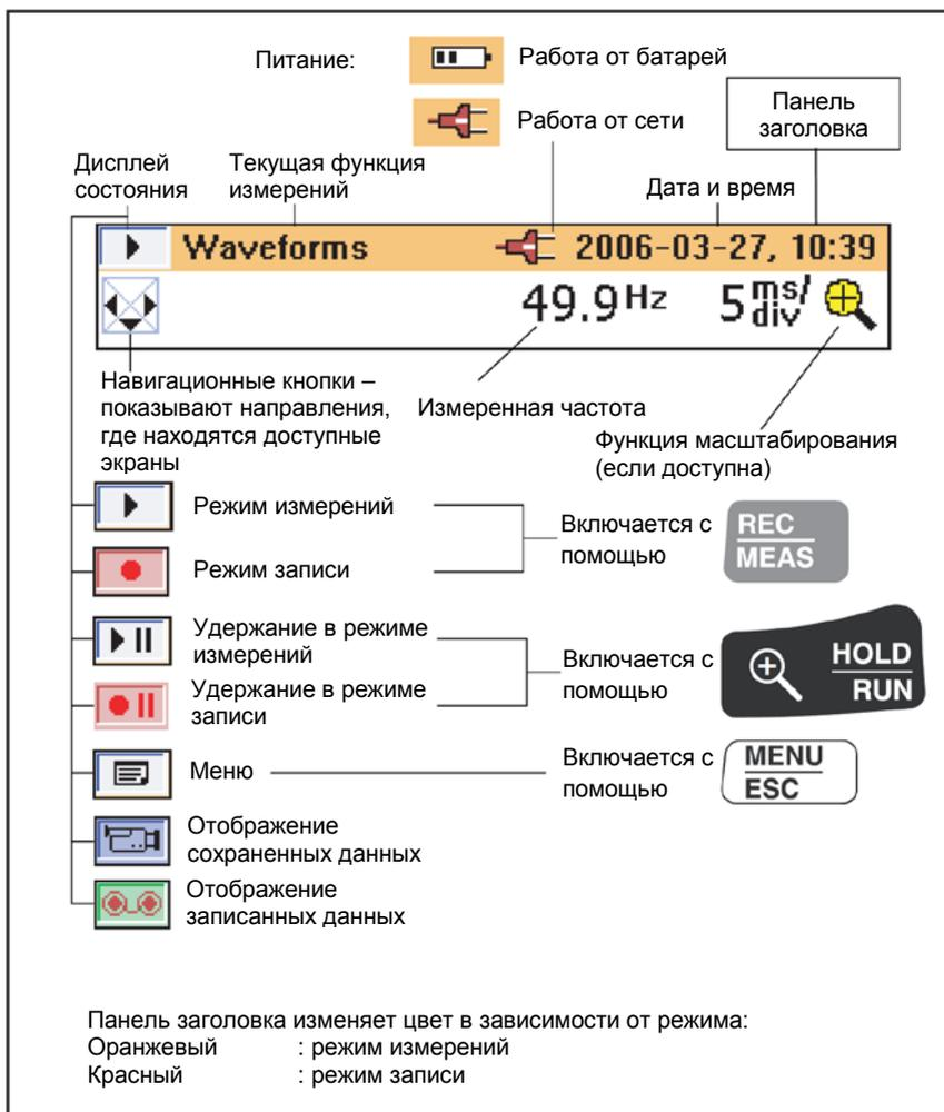
Рис. 10. Условные обозначения на дисплее измерительных клещей
