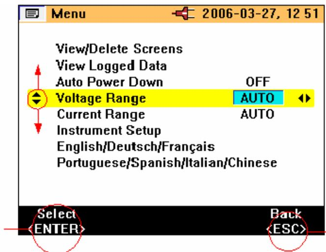
Рис. 11. Навигация по дисплею
