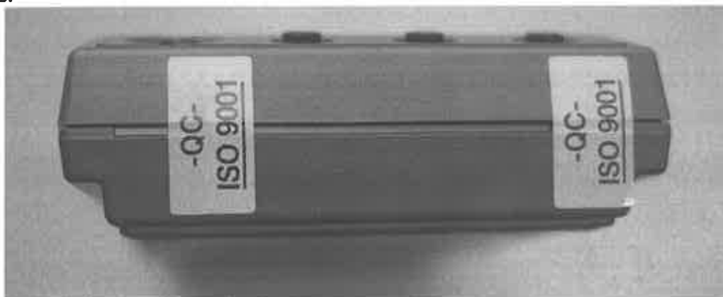
Рисунок 2 - Место пломбирования от несанкционированного доступа
