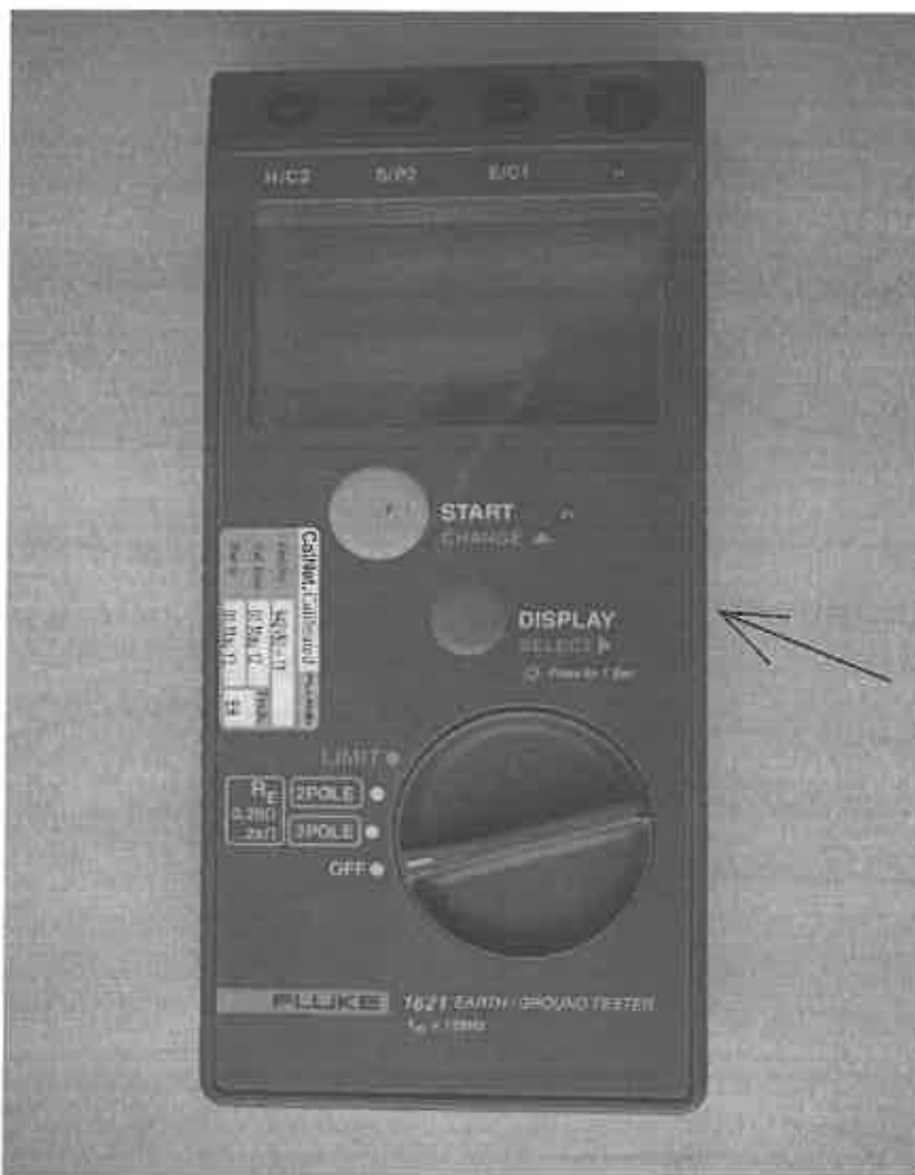
Рисунок 1 - Внешний вид тестера модели Fluke 1621, стрелкой показано место нанесения знака утверждения типа.
