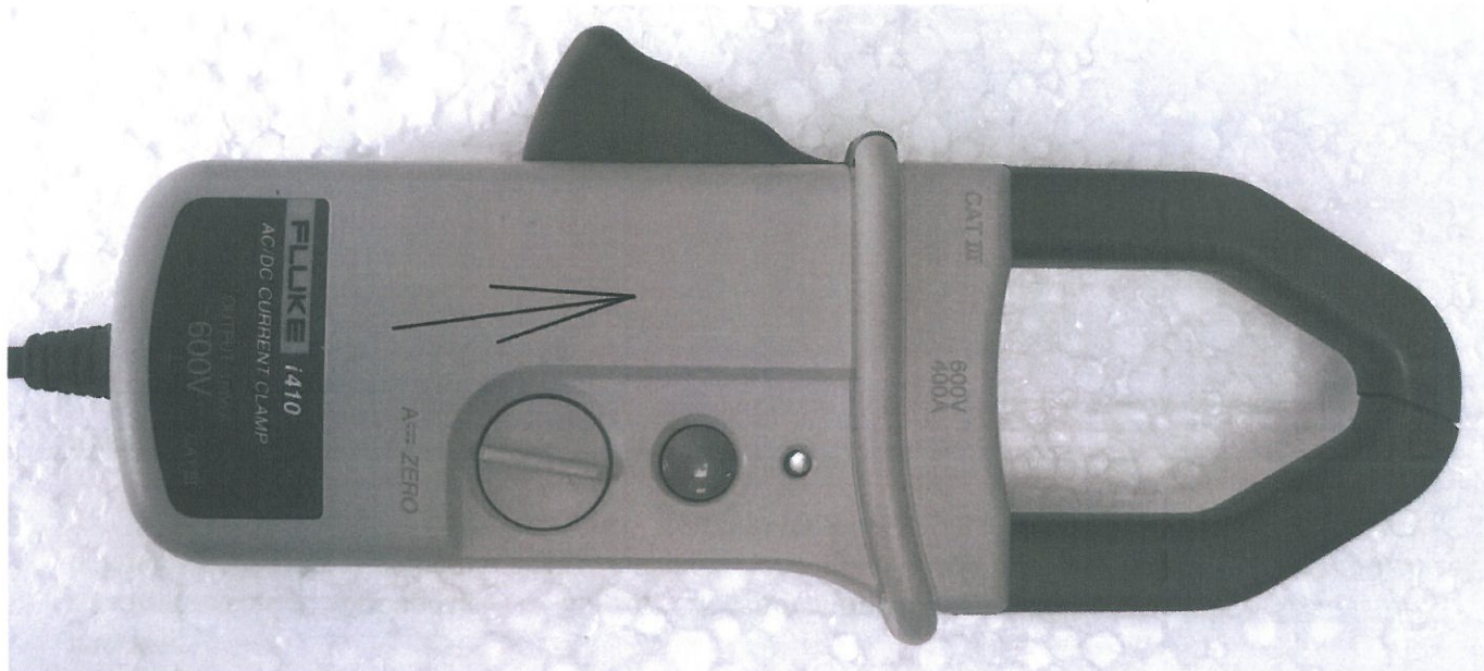
Рисунок 2 - Внешний вид клещей модели Fluke i800, стрелкой показано место нанесения знака утверждения типа.
