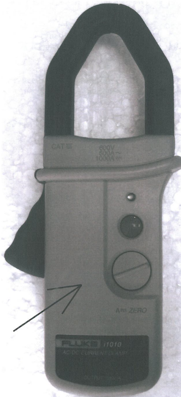
Рисунок 4 - Внешний вид клещей модели Fluke i1010, стрелкой показано место нанесения знака утверждения типа.
