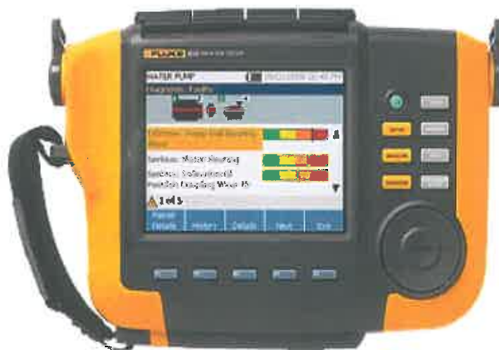
Рисунок 1 - Внешний вид виброметра FLUKE 810
